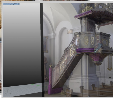
CAD-Rekonstruktion einer zerstörten Kirchenkanzel aus historischen Aufnahmen
