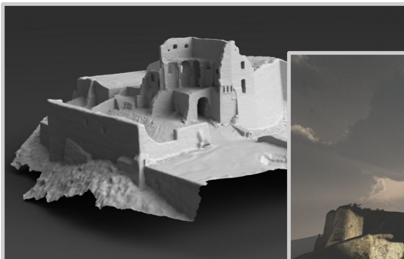
Burgruine. Mesh und texturiertes Mesh mit Visualisierung. Halbautomatisch abgeleitet aus hochdichter Punktwolke
